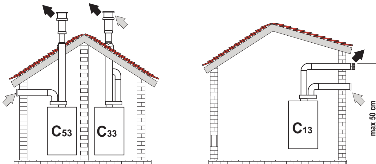
рис. 35- Примеры подсоединения с помощью отдельных труб
