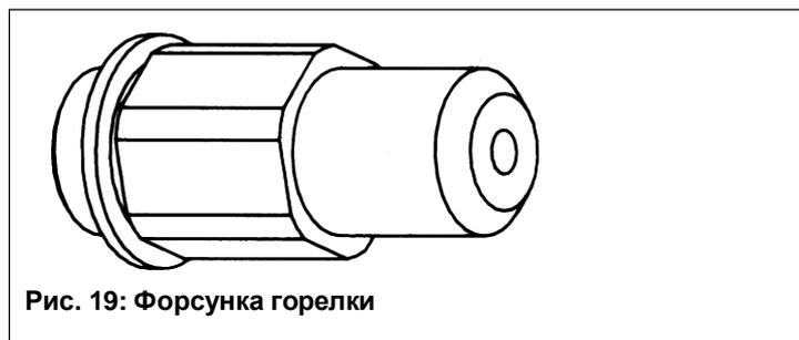
Рис. 19: Форсунка горелки
