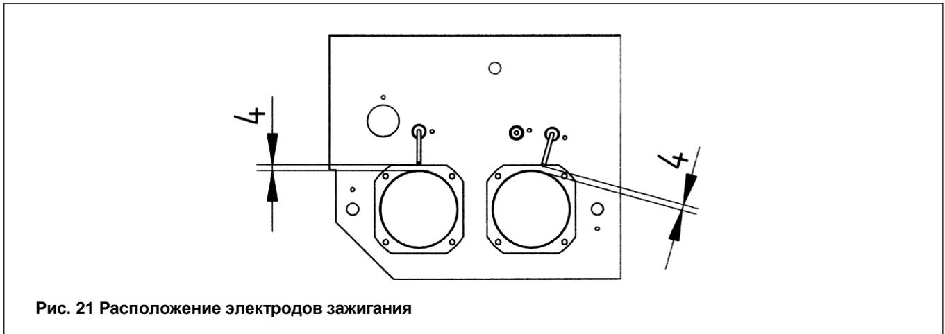
Рис. 21 Расположение электродов зажигания
