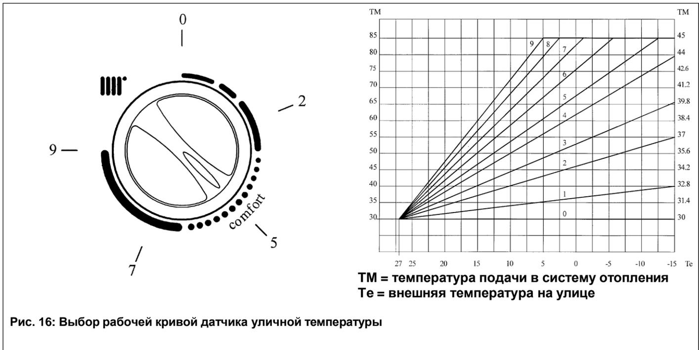
**Внимание:** Значение температуры подачи в систему отопления  $T_M$  зависит от положения переключателя T.RISC на плате (см. § 15). Максимальное значение устанавливаемой температуры равно 85 или 45 °C (по умолчанию установлено 85°C).
