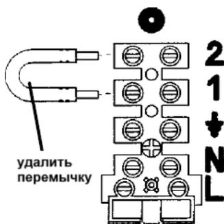
Присоединение регулятора по протоколу OpenTherm представлено на рис. 17.
