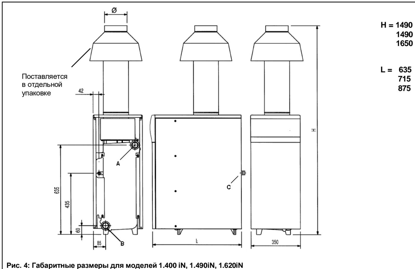
Рис. 4: Габаритные размеры для моделей 1.400 iN, 1.490iN, 1.620iN
