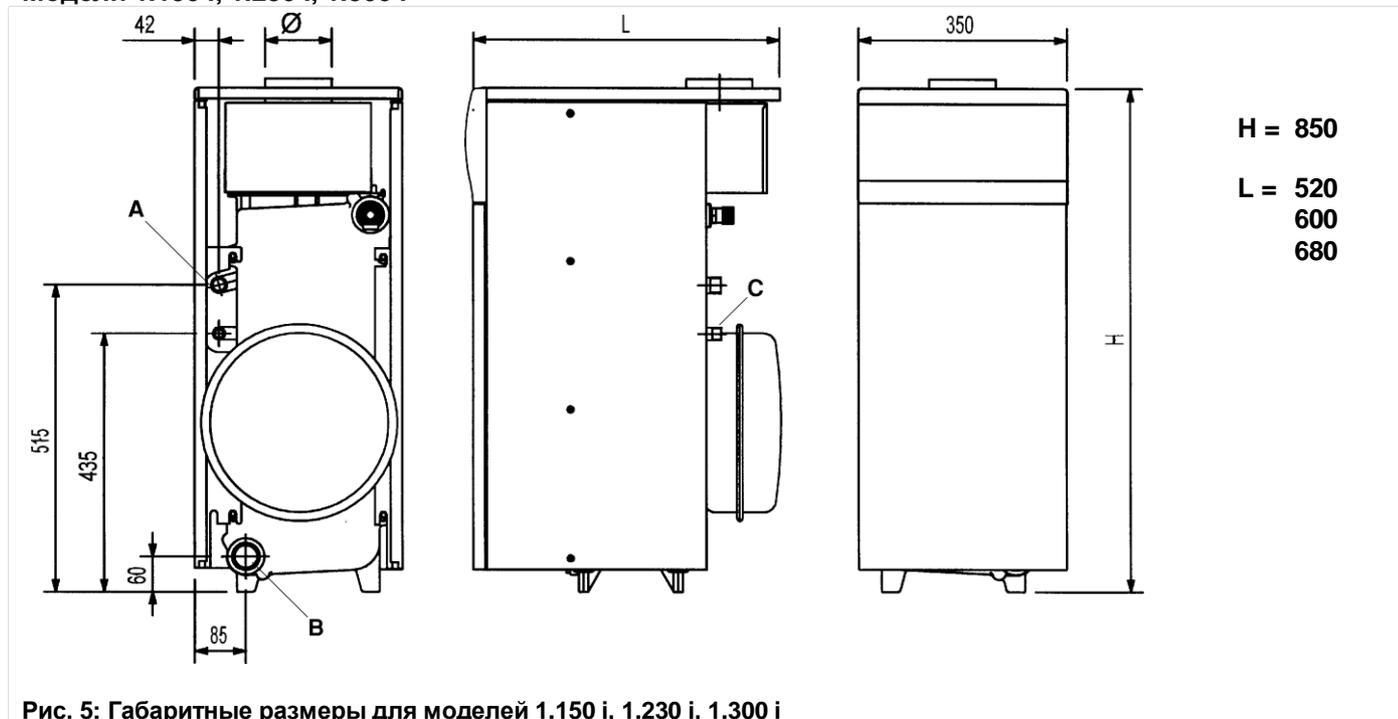
Рис. 5: Габаритные размеры для моделей 1.150 i, 1.230 i, 1.300 i
