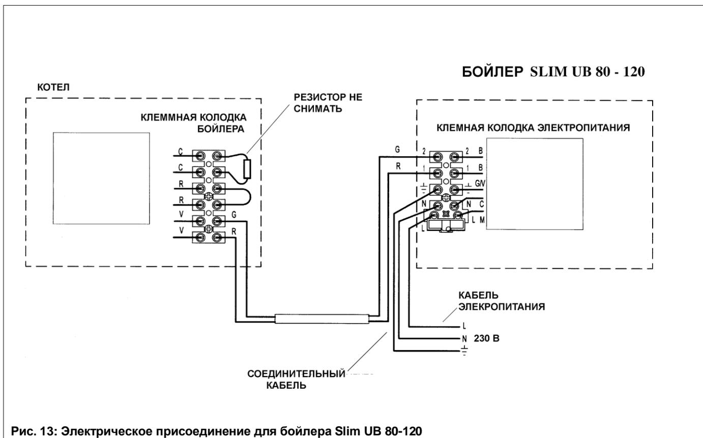
Рис. 13: Электрическое присоединение для бойлера Slim UB 80-120
