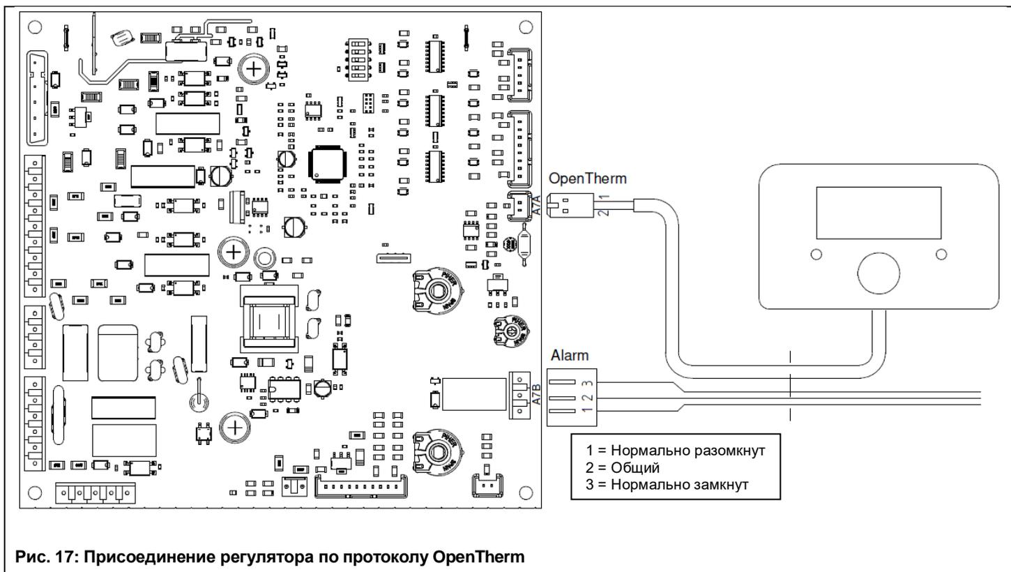
Рис. 17: Присоединение регулятора по протоколу OpenTherm
