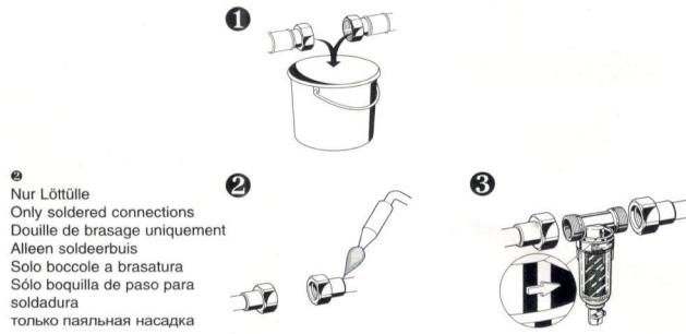
1.2 Wasserabführung • Water Drainage • Evacuation de l'eau de rinçage • Afvoer van het uitspoelwater • Scarico dell'acqua di lavaggio • Evacuación del agua de lavado • Слив воды для промывки
