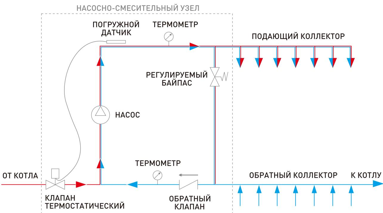
Насосно-смесительный узел ТИМ является узлом последовательного типа смещивания. Плюсом такого типа смещивания является то, что весь расход насоса идет потребителю.
