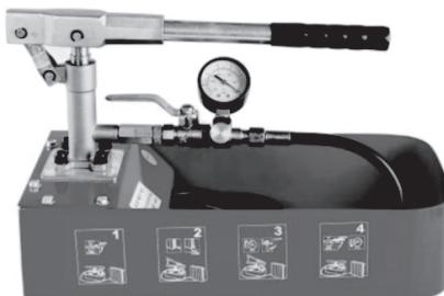
Ручной опрессовочный насос WM60 для точной и быстрой проверки давления, а также герметичности трубопроводных систем и резервуаров в водопроводных, отопительных и сантехнических системах, в системах сжатого воздуха, паровых, охладительных и масляных установках, для котельных и при строительстве напорных резервуаров, идеален для заполнения солнечных батарей.
