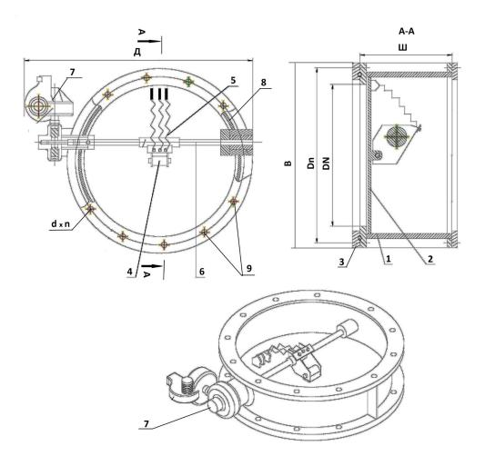
Рис. 1 Герметический клапан вентиляционный ГК ИА 1-Корпус, 2-Тарель (затвор), 3-Фланец, 4-Ось, 5-Пружина, 6-Вал, 7-Редуктор/Электропривод, 8-Прокладка, 9-Крепеж
