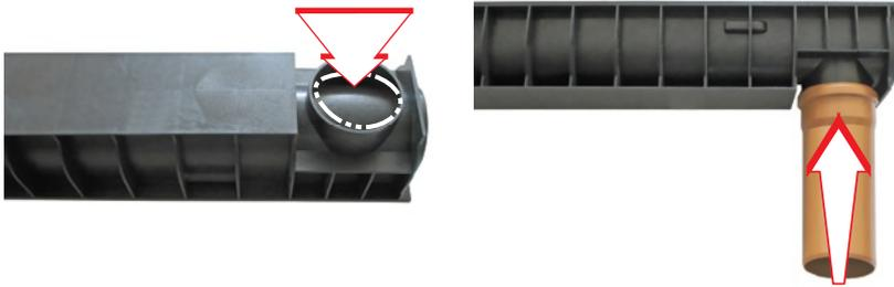
Перевернув канал, вырезать отверстие для соединения с дренажной трубой, в специальном обозначенном стыковочном узле.
